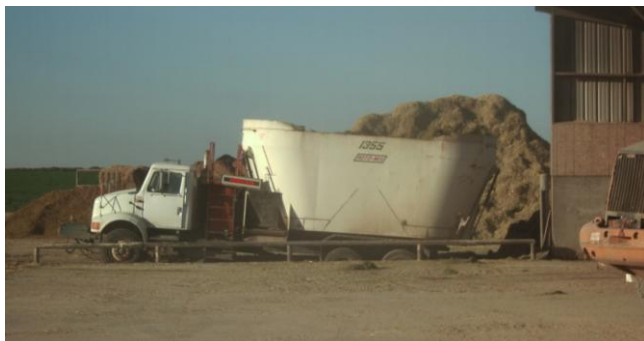
Foto 8. Mezcladora en una zona desnivelada – nivelación o reubicación de la zona de mezcla es recomendable
