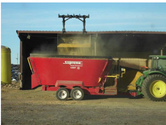
Foto 7. Mezclador desnivelado – se recomienda el ajuste del tractor.
