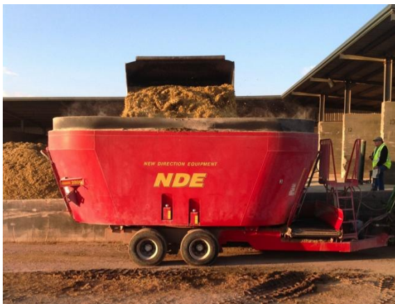
Foto 1. Ubicación correcta para la carga – centro del vagón mezclador.
